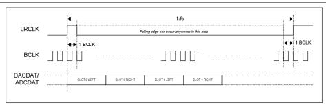
Figure 55 TDM in DSP Mode B
